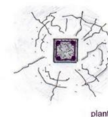
Falla por punzonamiento o penetración
